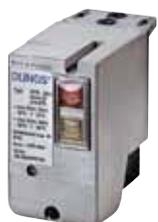
为检测燃气阀组的阀门密封状况,需选配“密封检测组件”。根据EN 676标准的规定,当锅炉的最大输出功率超过1200 kW时,燃气阀组必须配有此密封检测组件,其型号为VPS 504。
